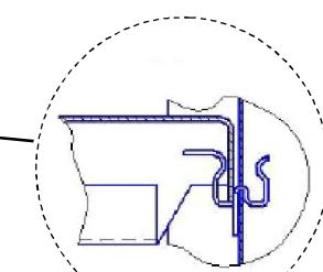
Двусторонний клип для установки полки на стойку.
