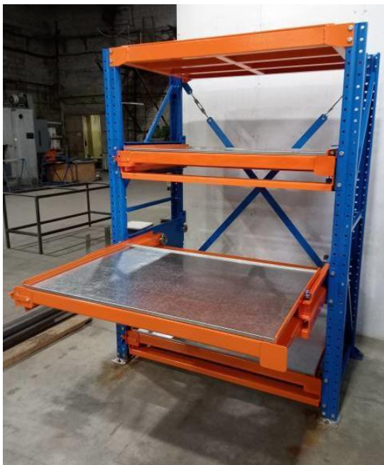
Рис 1 Стеллаж Slide. Полное выдвижение полки.
