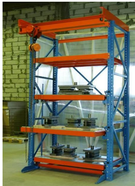
Рис 2 Стеллаж Slide со встроенной механической талью. Не полное выдвижение полки
